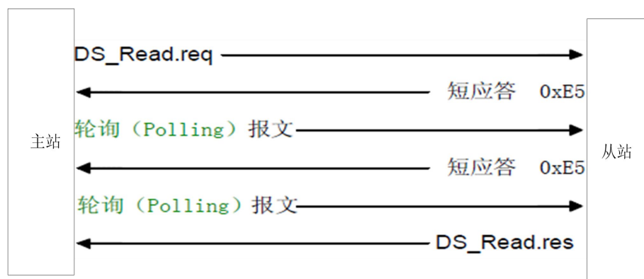
图 9 PROFIBUS-DPV1/C1 读非循环数据通讯机制
